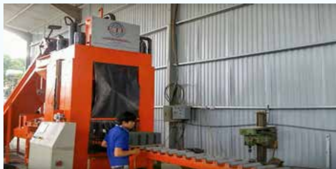
Hệ thống máy sản xuất gạch ống không nung xi-măng cốt liệu của Công ty TNHH Gạch ống không nung Ngôi sao Bình Dương (thị xã Tân Uyên) - Ảnh: CTV
