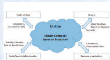
Hình 2. Nguyên lý quản lý tiện ích với công nghệ blockchain
